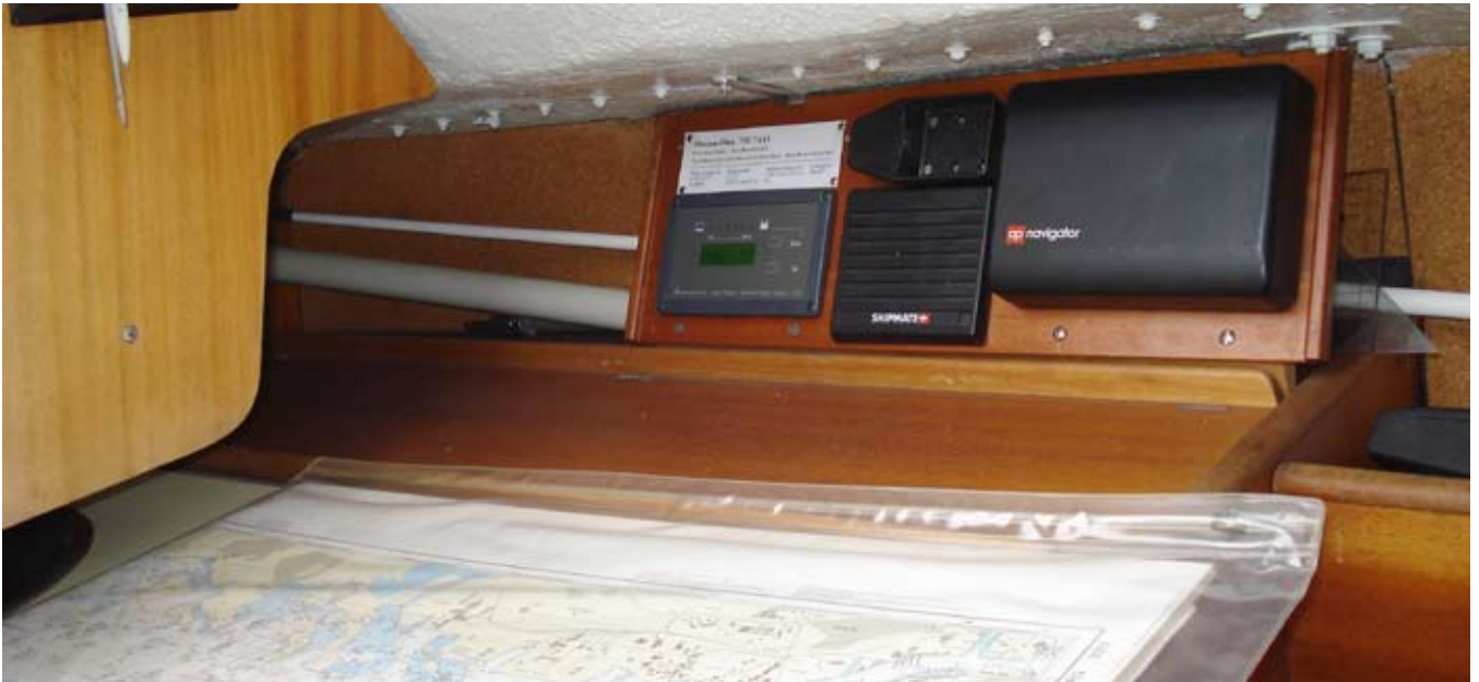
Instrumentpanel med batterimätare BTM-3 till vänster, VHF (här utan telefonlur) och GPS-mottagare. (I bakgrunden dels ett vitt plaströr med kablage och en lös VHF-antenn.)
